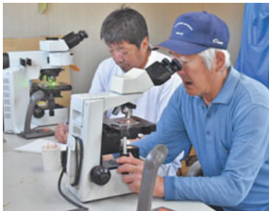
網の一部を切り取って顕微鏡で付着具合を確認
