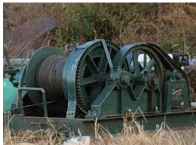
整備された漁船巻き揚げ機（左）
